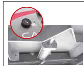
Bloqueo neumático de planchas deslizantes traseras.
