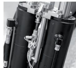
**Elevador y auxiliar equipados con doble sistema hidráulico**
