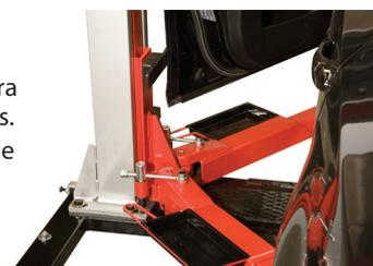
Carros provistos de **rodamientos de acero de alta calidad**. Sistema con **mucho menor desgaste** que los que deslizan mediante pastillas de Nylon.
